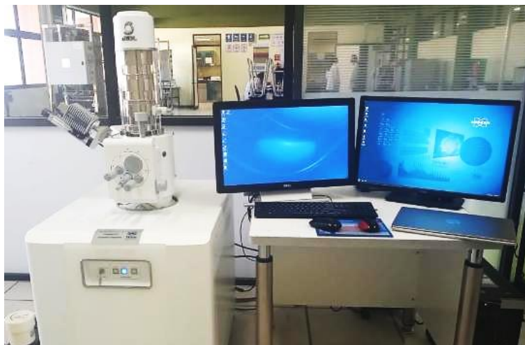
Figura 3.5 Microscopio Electrónico de Barrido acoplado a espectrómetro de rayos X de dispersión de energía (SEM-EDS).
